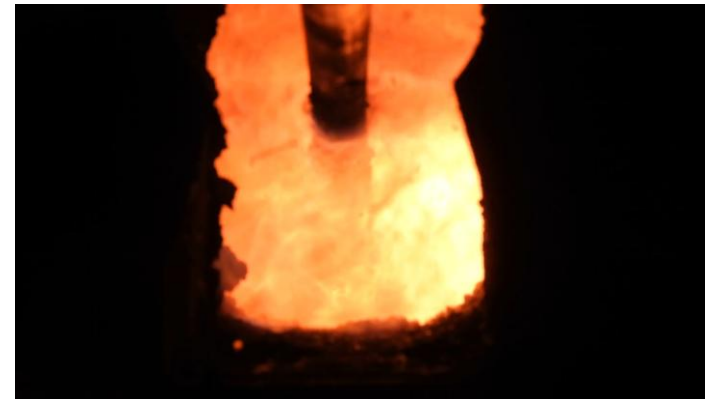
> 150 kg Schmelzphasen an der INEMET-Badschmelzanlage
