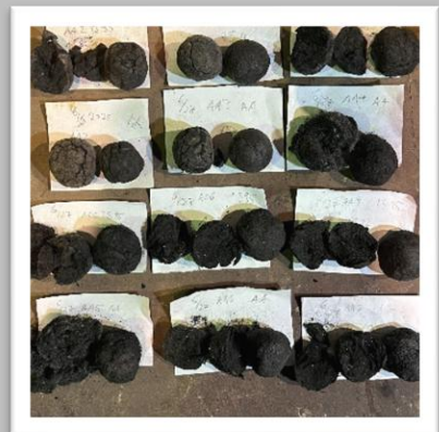
Handtestproben nach Drop-Test
